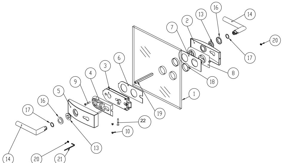
**image 1:** schéma de montage serrure pour porte en verre
