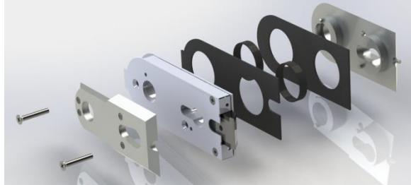
4. Dévissez la vis M5 et démontez le boîtier pièce par pièce.
