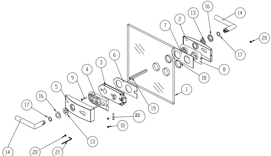
**Abb. 1:** Montageschema Glastürschlosskasten
